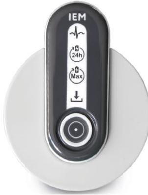
Die LEDs des Geräts zeigen den Ladevorgang deutlich an. Reicht die Akkuladung nicht für eine 24-Stunden-Aufnahme aus, blinkt die 24h-LED, und die Max-LED bleibt aus. Sobald die Ladung für eine 24-Stunden-Aufnahme ausreicht, leuchtet die 24h-LED dauerhaft, und die Max-LED beginnt zu blinken. Dies zeigt an, dass der Akku weiter geladen wird.
