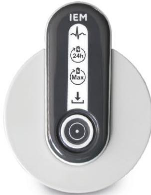
I LED del dispositivo forniscono chiare indicazioni sul processo di ricarica. Se la carica della batteria non è sufficiente per 24 ore di registrazione, il LED 24h lampeggia e il LED Max rimane spento. Quando la carica raggiunge un livello sufficiente per una registrazione di 24 ore, il LED 24h rimane acceso fisso e il LED Max inizia a lampeggiare per segnalare che la ricarica della batteria è ancora in corso.
