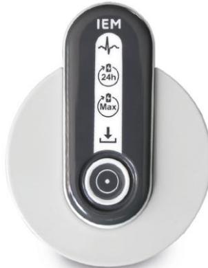
Les LED de l'appareil fournissent des indications claires sur le processus de charge. Lorsque la charge de la batterie est insuffisante pour un enregistrement de 24 heures, la LED 24h clignote et la LED Max reste éteinte. Lorsque la charge atteint un niveau suffisant pour un enregistrement de 24 heures, la LED 24h reste allumée de manière fixe et la LED Max commence à clignoter, indiquant que la batterie continue à se charger.
